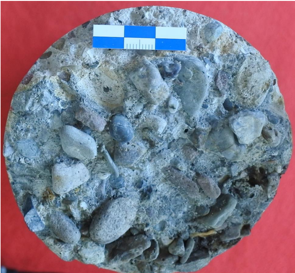
Bild 4: Innenseite des Faulturms, Bohrkern 19/0980-2
