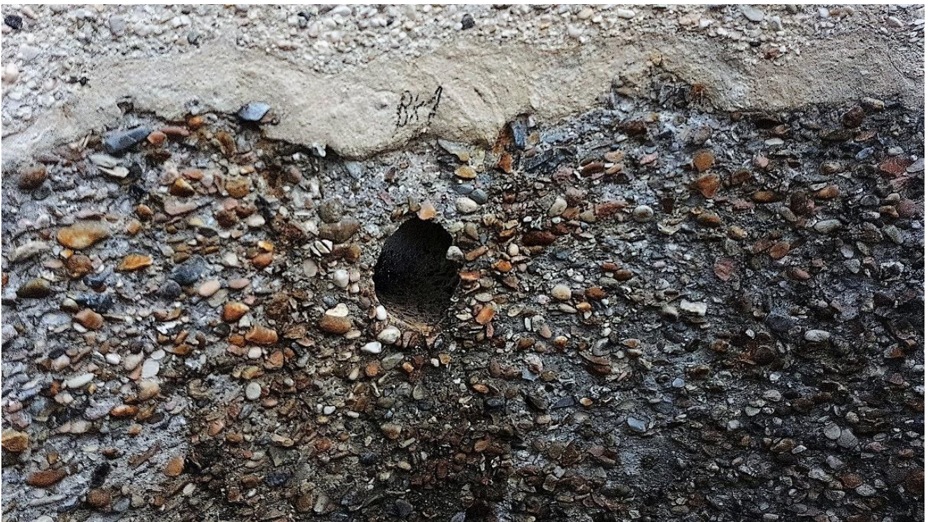
Bild 1: Bohrkernentnahmestelle 1
